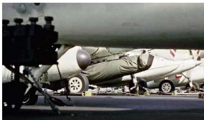
Zur Zeit des Kalten Krieges bis etwa Mitte der 60er Jahre hatten auch die Kampfflugzeuge der US Navy taktische Nukleareinsätze zu fliegen. Auf dieser seltenen Aufnahme auf dem Jahre 1964 ist eine solche Waffe (Mk 7) an einem A-1H «Skyraider» der Attack Squadron 65 auf dem Atomflugzeugträger USS «Enterprise» (CVAN-65) aufgehängt.
