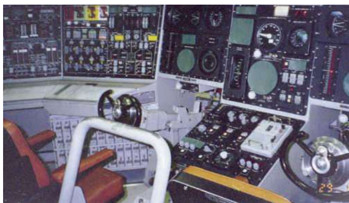
Die Steuerkonsole auf dem ballistischen Lenk Waffenuboot USS «Maine» (SSBN-741), dem drittneuesten «Boomer» der «Ohio»-Klasse. Das Boot wurde 1995 in Dienst gestellt. Links ist der Arbeitsplatz des Tauch-Rudergängers (Tiefensteuerung – planesman), rechts jener des Rudergängers (Seitensteuerung – helmsman).
