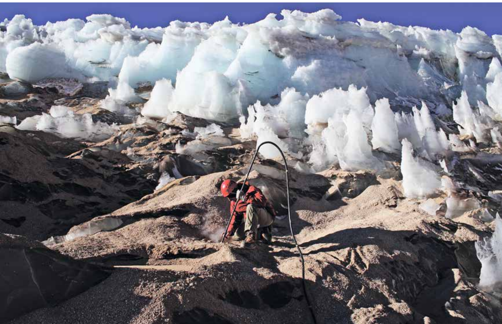
Instalación de una baliza de ablación en un área cubierta de escombros con el fin de evaluar el derretimiento del glaciar Toro, Valle del Huasco.
