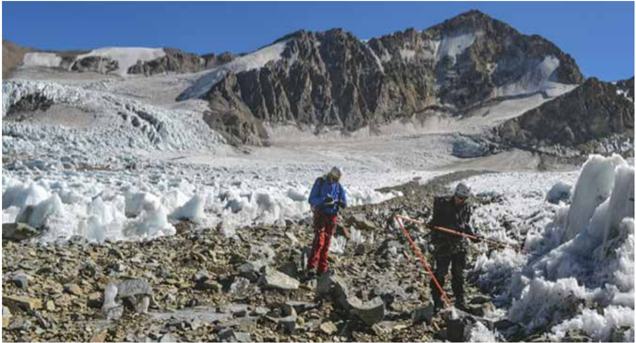
Medición de balizas de ablación en el glaciar Bello, Región Metropolitana, marzo de 2018. Se aprecian dos secciones de 1,5 m de longitud de la baliza de pvc color naranja, que al momento de su instalación, en octubre de 2017, estaban completamente hundidas en la nieve y hielo.
