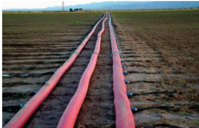
**Foto 15.** Tubería LAYFLAT.
