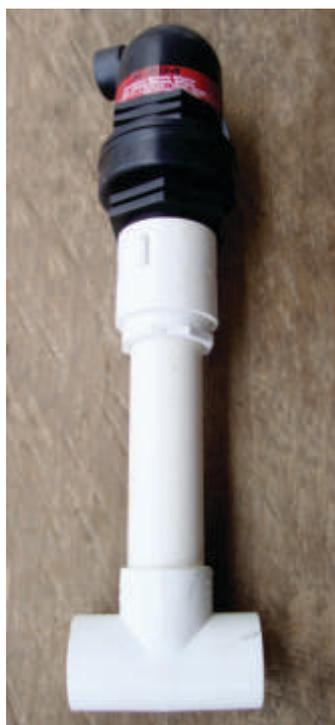
Foto 101. Válvula de aire de 2" armada.
