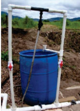
Foto 30. Inyector de fertilizante Venturi.
