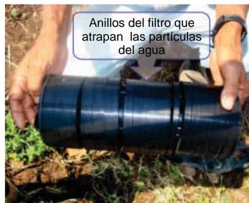
**Foto 49.** Anillos que atrapan el sucio del agua de riego.
