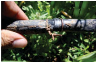
**Foto 92.** Reparación de fuga con tubín alambre de amarre.
