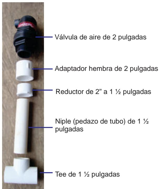
Foto 102. Partes de la válvula de aire.
