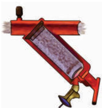
**Fig. 26.** Filtro de malla instalado.
