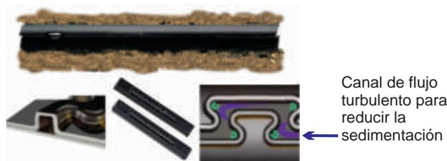
Fig. 28. Diagrama de cinta de riego por goteo.
