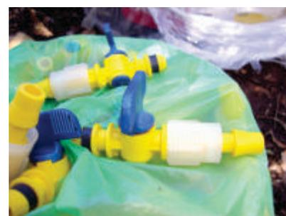
**Foto 60.** Conector inicial de PVC a cinta de riego con válvula.
