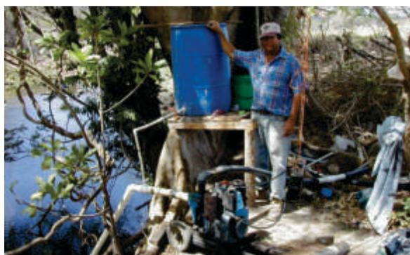
**Foto 34.** Inyección directa del barril por la succión de la bomba.
