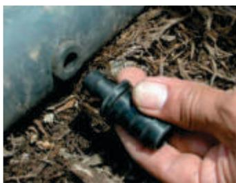
Foto 98. Conector Inicial de tubo a polietileno.
