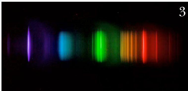
FIGURA 3. Espectro de una lámpara fluorescente moderna observado con el espectrógrafo casero descrito en este artículo como paso previo para ajustar la correcta alineación de la rendija.
