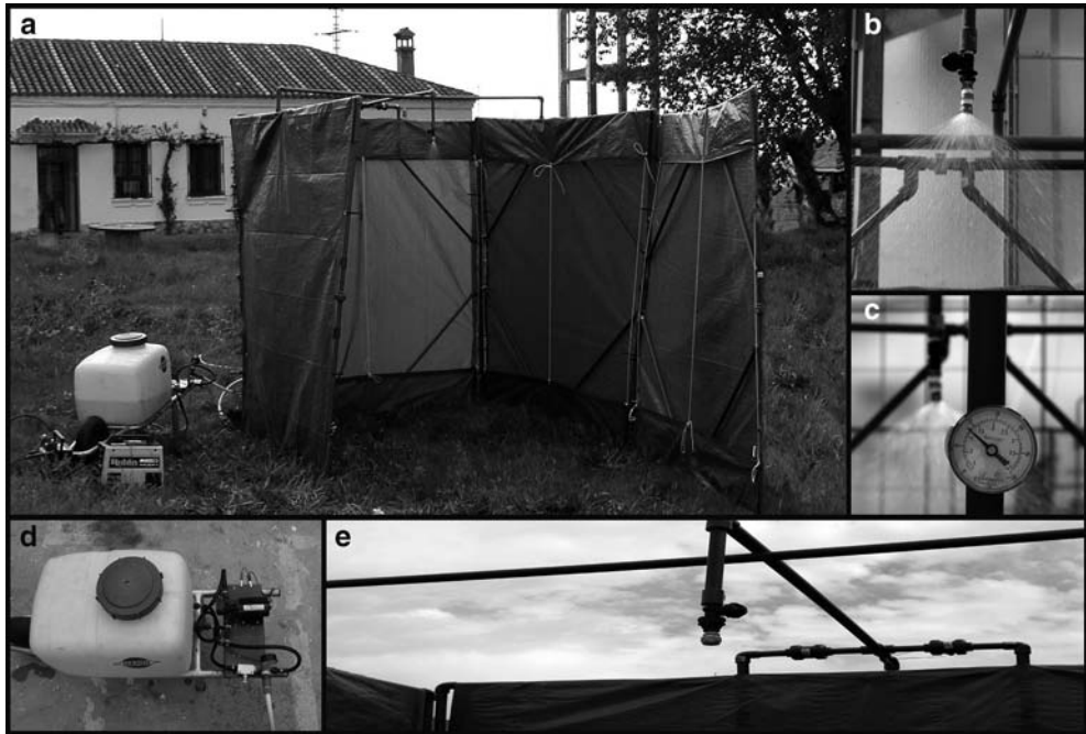
FIGURA 2: Simulador de Lluvia: a) Estructura General; b) Boquilla 3/8 HHMFP 115 14 (Spraying Systems Co.); c) Manómetro y Boquilla; d) Depósito, Bomba y Regulador de Presión; e) PortaBoquillas.
