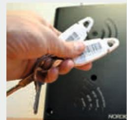
**Mobiler UHF RFID Scanner mit Antenne:** Ermöglicht das Erfassen mehrerer Schlüssel gleichzeitig und das Auslesen aus grösserer Distanz
