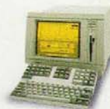
El integrador Personal PE Nelson Modelo 1020, con gráficas en pantalla y un disco de 20-MB.
