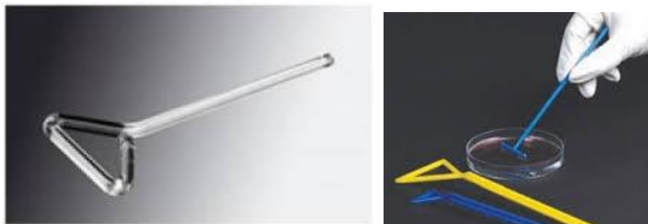
Figura 5.2 – Alça de Drigalsky, de vidro e descartável, utilizada para espalhar os micro-organismos no ágar.
