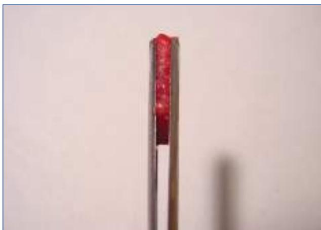
**Figura 9.** Pinza de captura, una vez extraída, que contiene el cilindro.
