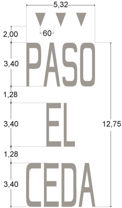
M-11.8b Leyendas para vías con velocidad mayor a 50 km/h
