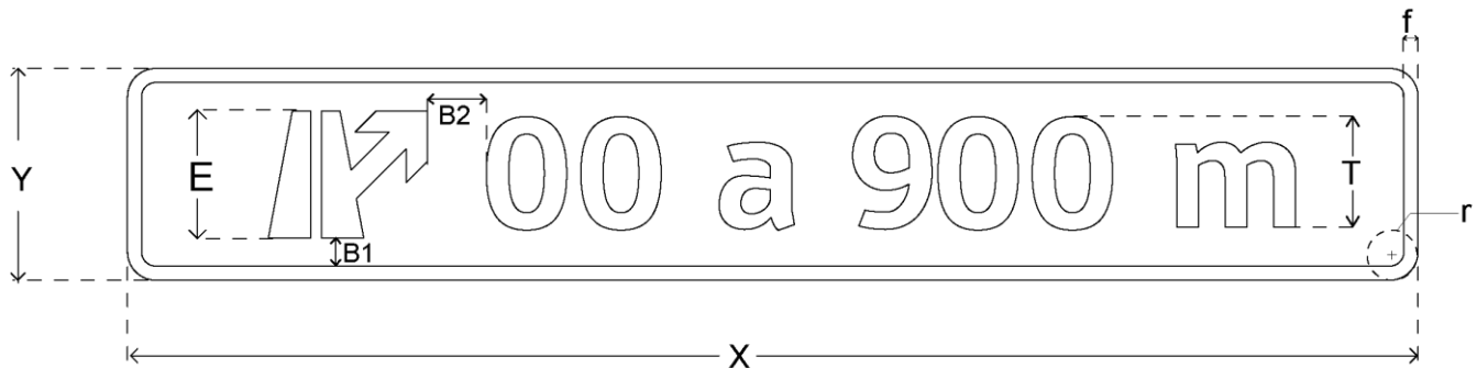
IMAGEN 7.43 TRAZO DE LA SEÑAL INFORMATIVA DE IDENTIFICACIÓN SII-6b NOMENCLATURA EN SEÑAL ELEVADA
