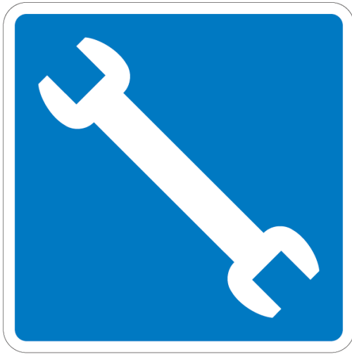
SIS-16a SERVICIO MECÁNICO DE VEHÍCULOS MOTORIZADOS
