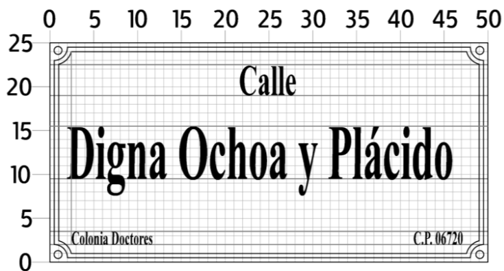
IMAGEN 7.8 TRAZO EN RETÍCULA DE LA SEÑAL SII-6b.2. SII-6b.2 Nomenclatura baja adosada a muro color azul para zonas de monumentos históricos
