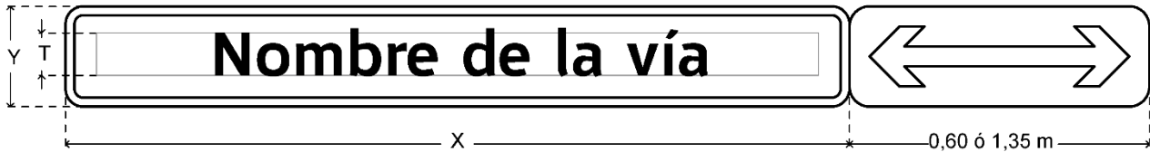
IMAGEN 7.13 DEMENSIONES DE LA SEÑAL SII-6d.1. Nomenclatura en señal elevada USM
