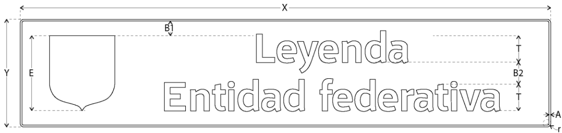
IMAGEN 9.5 EJEMPLO DE TRAZO DE LAS SEÑALES DE LÍMITE DE DEMARCACIÓN
