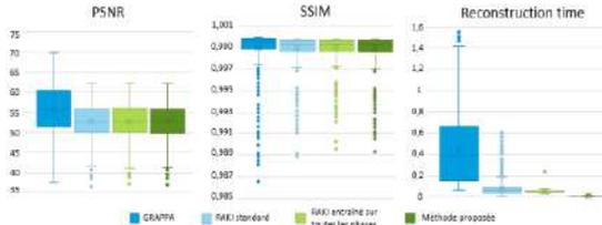
**Figure 2 :** Boîtes à moustaches du PSNR, SSIM et du temps de reconstruction pour toutes les méthodes à R=4.
