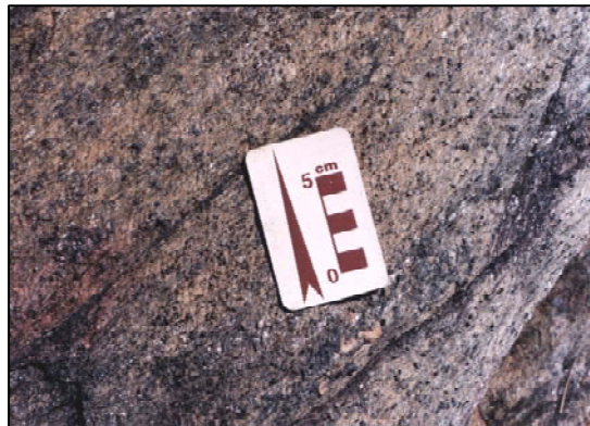
Figura 24: Detalhe da rocha xistosa mostrada na Figura 23, evidenciando foliação anastomosada e cristais maiores de magnetita, com até 2 milímetros de tamanho. Coordenadas UTM: 737855/8334050.
