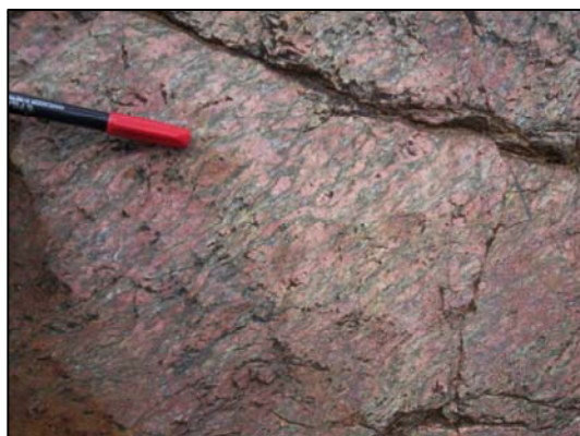
Figura 49: Rocha da Suíte Paciência mostrando orientação dos fenocristais de feldspato. UTM: 719732/8316055.
