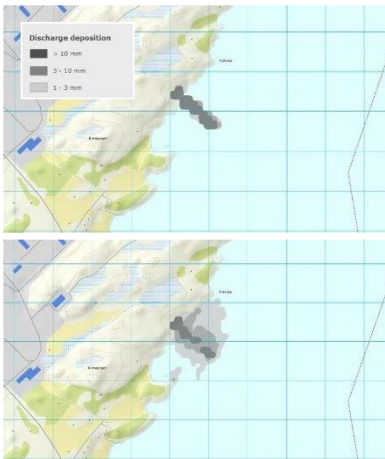
Figur 8-1. Resultater fra modellering av partikkelspredning og sedimentasjon fra installering av stein i forbindelse med landfall. Påførsel av 6000 m 3 stein i løpet av 7 dager over 250 m strekning. Scenario med påførsel 2m over havbunn (øverst) og 2m under vannflaten (nederst). Ei rute er 100m.
