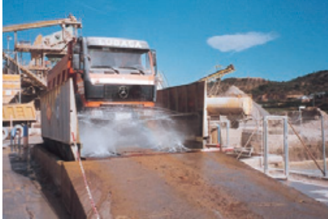
Ilustración 77 Lavado bajos camión
