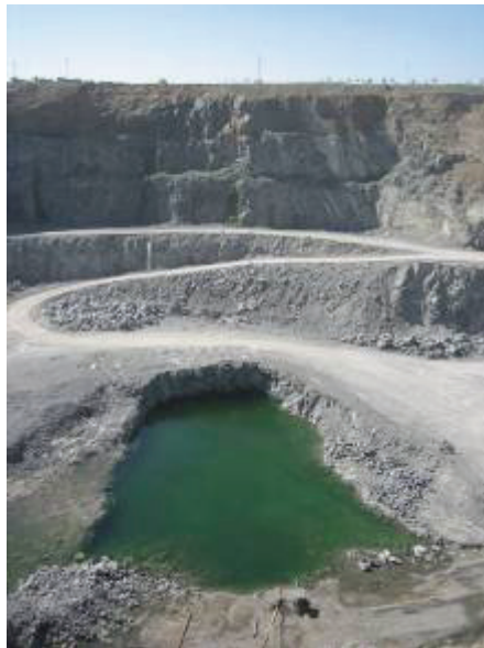
Ilustración 3 Acumulación aguas pluviales
