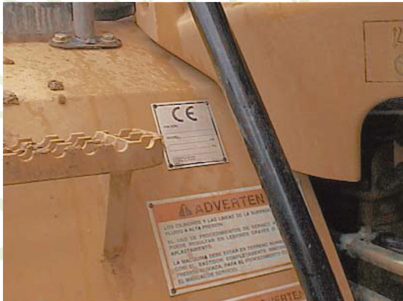
Ilustración 73 Maquinaria con marcado CE
