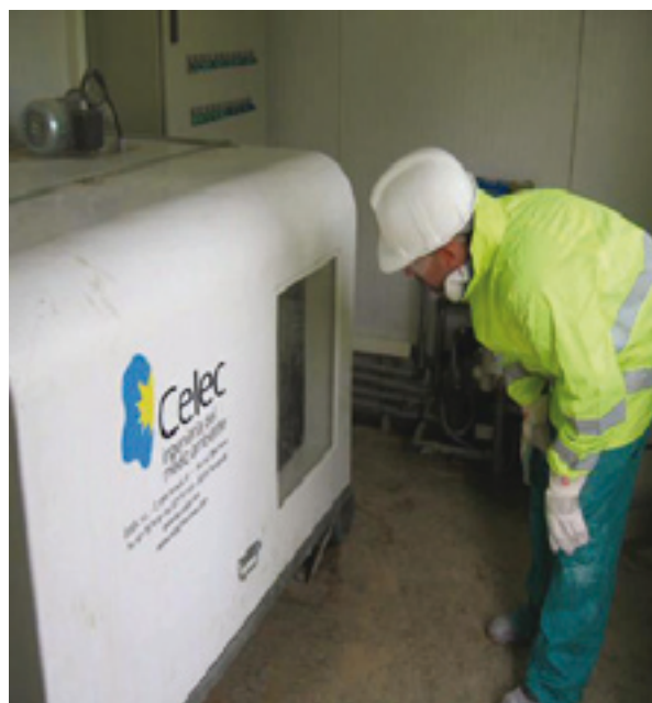
Ilustración 56 Sistema CELEC para el control del polvo
