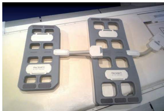
Fig. 7 : Antenne en réseau phasé "flex", souples de différentes tailles.
