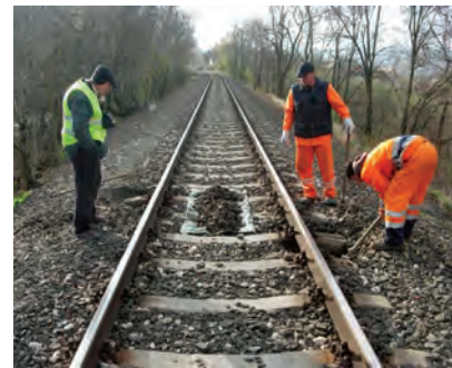
10. ábra. Mintavétel az ágyzati kőanyagból
