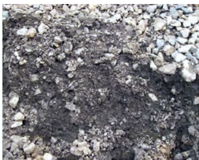
8. ábra. Aprózódott és szennyeződött ágyazati anyag
