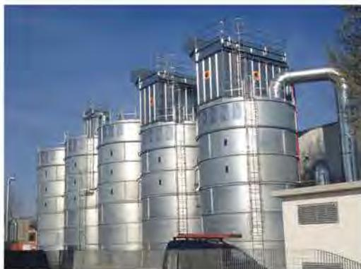
Silos di stoccaggio ATEX per polveri
