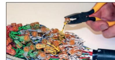
3M™ Scotchlok™ Schneidklemmzange E-9Y
