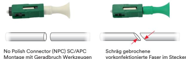
No Polish Connector (NPC) SC/APC Montage mit Geradbruch Werkzeugen
