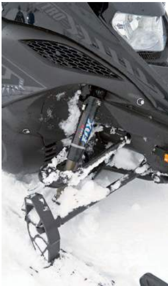
Fram sitter det fortfarande FOX Float-dämpare på X-Ride, det nya är att allt lackats svart i framvagnen.
