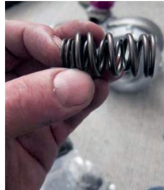
Dubbla ventilfjädrar av race-typ är ett måste i en motor som denna.
