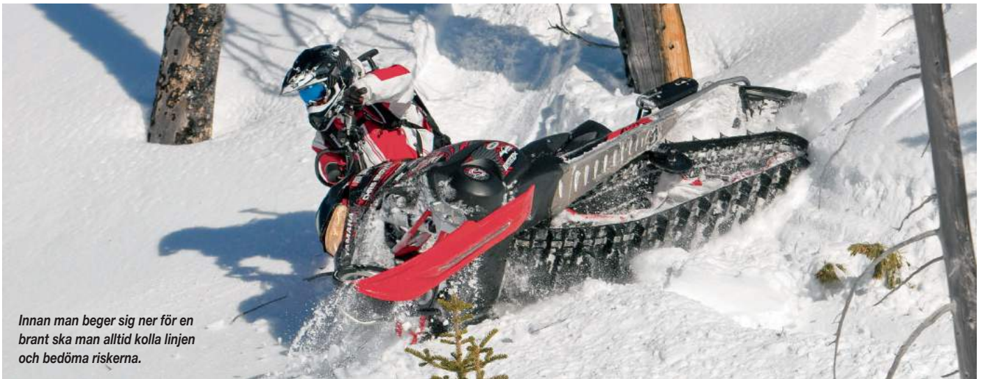
Ju längre fram foten är kommer skotern hålla sin linje eller åka nedåt, flyttar man den bakåt kommer skotern vilja vända uppåt.
