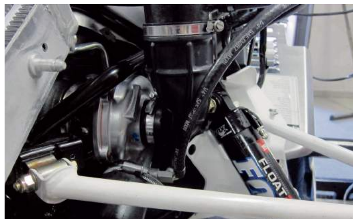
Luften i till turbon passerar en mycket snäv 90 graders böj, inte riktigt rätt om man önskar högre effekt än standard.
