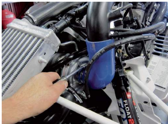
Med denna specialböj i silicongummi ökar flödet in i turbons kompressor.
