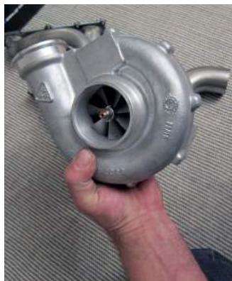
Detta är hjärtat i anläggningen, en MCX550-laddare.
