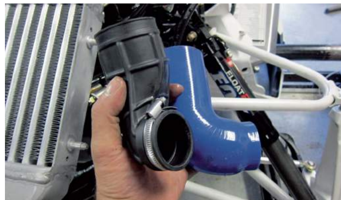
Skillnaden mellan standard och den nya insugs slangens är stor.
