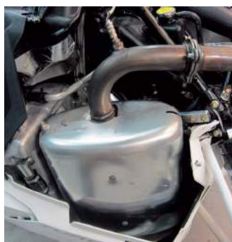
Standard ljuddämpare är en bastant pjäs på hela 7,8 kg.
