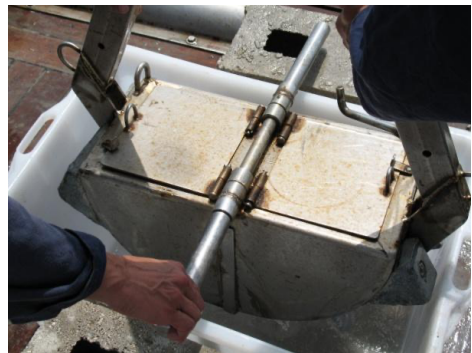
Figura 2- Alloggiamento della benna chiusa nell'apposito vascone ed ispezione del contenuto della benna tramite gli appositi sportelli.
