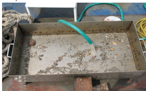
Figura 3 - Setacciatura del campione tramite lavaggio dello stesso nella vasca di raccolta.
