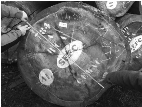
Fig. 3 Esempio di misura del diametro di un tronco effettuata escludendo l'alburno. Log diameter measured under sapwood.
