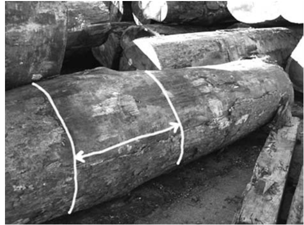
Fig. 4 Zona di tronco esclusa dalla misura della lunghezza per presenza di difetti. Part of log excluded by the length measure because of the presence of wood defect.
