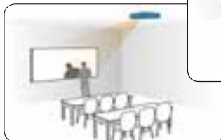
Mit anderen Beamern: Vortragender steht im Lichtkegel, Schattenwurf, Sichtbehinderung
