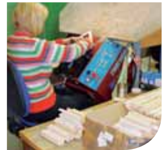
Rahmenfertigung An mehreren Stationen werden die Rahmenprofile mit den Rückwänden komplettiert.
