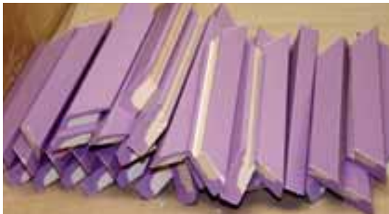
Gehungseinfärbung Die Kanten der Holzprofile werden manuell eingefärbt, um Blitzer beim Zusammensetzen zu vermeiden.
