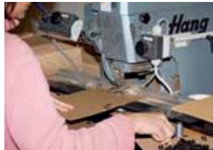
Easy Clip Stanzung Die Montage der Easy Clips erfolgt über eine manuell zu bedienende Nietmaschine.
