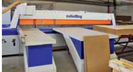
Rückwandsäge Massenproduktion von Rückwänden in sämtlichen Größen wird hiermit möglich.
