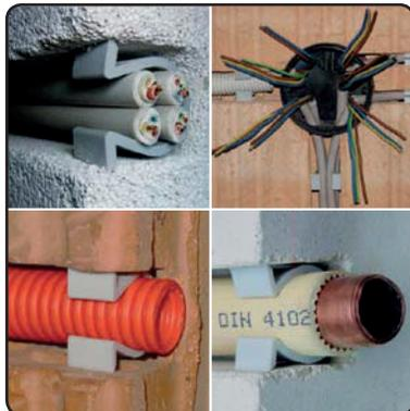
Der Typ B fixiert in gefrästen Schlitzten mehrere Leitungen oder Installationsrohr bis Ø 25 mm. Dies entspricht z.B. Mantelleitung 5x10mm<sup>2</sup> oder vier Leitungen NYM 3x1,5 mm<sup>2</sup>.
