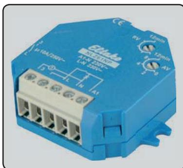
Nachlaufschalter werden z.B. in innenliegenden Bädern eingesetzt, um die Abluftsteuerung des Ventilators zu gewährleisten. Nachlaufschalter haben zwei Schalmöglichkeiten, zum einen ist die Zeit einstellbar wann der Lüfter nach Betätigung des Lichtschalters anlaufen soll, zum zweiten ist die Zeit einstellbar, die der Lüfter nach ausschalten des Lichtes nachlaufen soll. Nachlaufschalter werden mit dem Schalter für die Raumbelichtung gekoppelt, und auf der Hutschiene im Verteilerkasten montiert.
