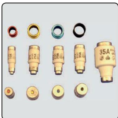
Der Schmelzeinsatz weist neben einer Aufschrift der Nennstromstärke, der Nennspannung und der Betriebsklasse (Betriebsklasse in der Hausinstallation ist meist gL für Ganzbereichs- Kabel- und Leitungsschutz) auch eine Farbcodierung am Kennmelder (auch Anzeiger genannt) am Kopfkontakt.
