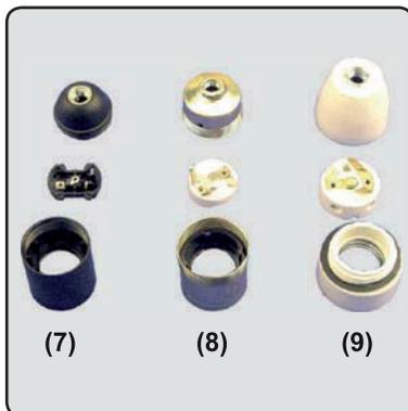
Es gibt Fassungen aus Kunststoff (7), Fassungen aus Metall (8) und Fassungen aus Porzellan (9). Diese drei Ausführungen haben unterschiedliche Temperaturbeständigkeiten und können daher mit unterschiedlichen Leuchtmitteln betrieben werden.
