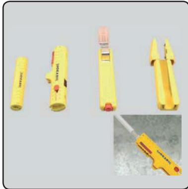
Abmanteln ist ein Abziehen oder Auftrennen des Leitungsmantels, z.B. von Mantelleitungen NYM mit einem Kabelmesser oder Kabelentmantler.
