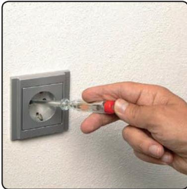
Der Phasenprüfer ist ein einfaches Prüfmittel zum Feststellen von Wechselspannungen im Spannungsbereich von 100-250 V~.
