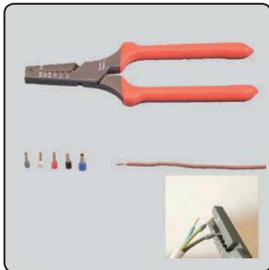
Bei feindrätigen Leitern müssen auf die Leiterenden Aderendhülsen aufgeschoben und mit einer Aderendhülsenzange festgequetscht werden.
