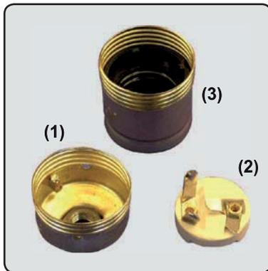
Metall-Lampenfassungen bestehen aus drei Teilen: dem Oberteil (1), dem Isolierteil (2) und dem Gewindeteil (3).
