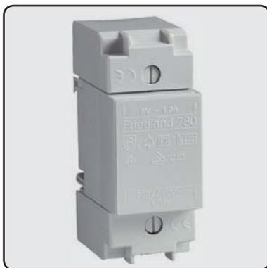
Mit Klingeltransformatoren (auch kurz Klingeltrafo genannt) erfolgt die Spannungs- bzw. Stromversorgung einer Klingelanlage. Der Klingeltrafo wird üblicherweise in den Zählerschrank oder einen Unterverteiler eingebaut. Klingeltrafos benötigen eine Eingangsspannung von 230V~ und liefern üblicherweise eine Ausgangsspannung von 8 V~. Je nach Stromaufnahme des angeschlossenen Gongs wird ein Klingeltrafo mit 1 A oder 2 A benötigt.
