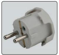
Für Geräte der Schutzklasse I sind Schutzkontaktstecker vorgeschrieben, da hier alle elektrisch leitfähigen Gehäuseteile mit dem Schutzleiter verbunden sein müssen.
