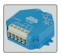
Nachlaufschalter werden z.B. in innenliegenden Bädern eingesetzt, um die Abluftsteuerung des Ventilators zu gewährleisten. Nachlaufschalter haben zwei Schaltmöglichkeiten, zum einen ist die Zeit einstellbar wann der Lüfter nach Betätigung des Lichtschalters anlaufen soll, zum zweiten ist die Zeit einstellbar, die der Lüfter nach ausschalten des Lichtes nachlaufen soll. Nachlaufschalter werden mit dem Schalter für die Raumbeleuchtung gekoppelt, und auf der Hutschiene im Verteilerkasten montiert.
