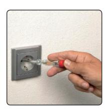
Der Phasenprüfer ist ein einfaches Prüfmittel zum Feststellen von Wechselspannungen im Spannungsbereich von 100-250 V~.
