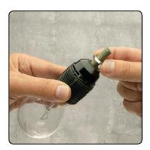
Fassungen werden meist mit Gewinderöhrchen und Muttern an der Leuchte befestigt. Die Gewinderöhrchen werden hierzu in das M 10x1- Gewinde der Fassung eingeschraubt.
