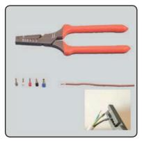
Bei feindrähtigen Leitern müssen auf die Leiterenden Aderendhülsen aufgeschoben und mit einer Aderendhülsenzange festgequetscht werden.
