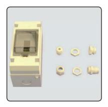
Bei der Feuchtraum-Installation müssen die Leitungseinführungen gegen Eindringen von Feuchtigkeit mit Würgenippeln oder Kabelverschraubungen abgedichtet werden.
