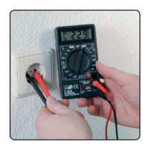
Das Digital-Multimeter eignet sich zur Messung von Gleich- und Wechselspannung sowie Gleichstrom, zur Ermittlung eines Widerstandes und zum Diodentest. Auch ein akustischer Durchgangsprüfer ist eingebaut.
