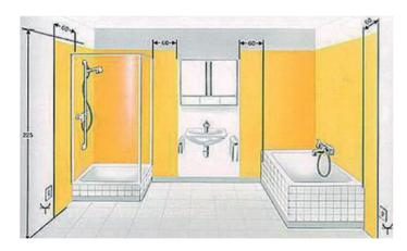
In Bädern besteht aufgrund der Feuchtigkeit eine besondere Gefährdung. Daher dürfen in die gelb gezeichneten Bereiche keine Schalter und Steckdosen installiert und keine Leitungen in oder unter Putz verlegt werden.
