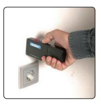
Das Metall- und Leitungssuchgerät dient zum einfachen Auffinden von Metallteilen und spannungsführenden Leitungen.
