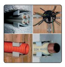
Der Typ B fixiert in gefrästen Schlitzen mehrere Leitungen oder Installationsrohr bis  $\emptyset$  25 mm. Dies entspricht z.B. Mantelleitung 5x10mm² oder vier Leitungen NYM 3x1,5 mm².
