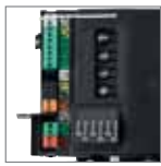
Programmier-Interface und herausnehmbare Klemmenleisten
