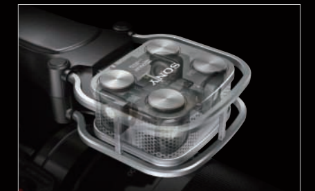
Microphone capsule structure 麦克风胶囊结构
