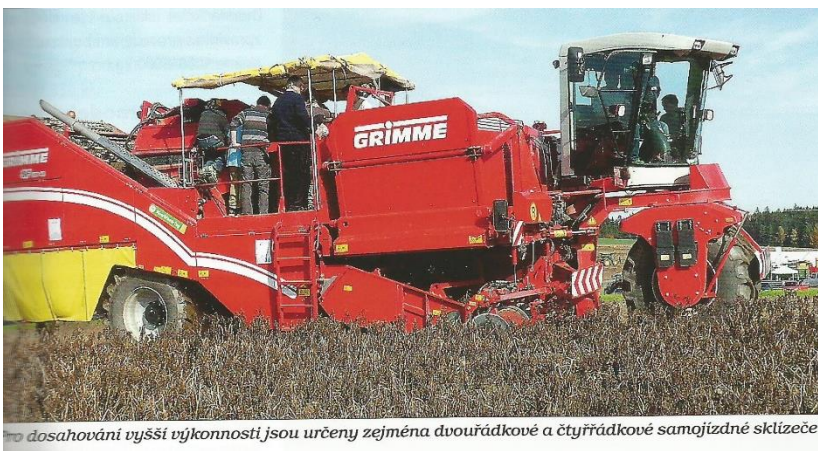
Obr. Samochodný sklízeč brambor se zásobníkem
