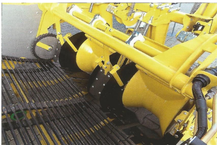
Detailní pohled na možné provedení dvouřádkového vyorávacího ústrojí s navazujícím prutovým dopravníkem
