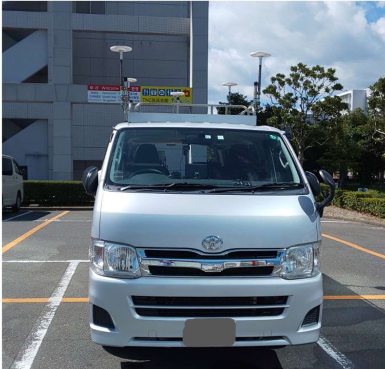
図 5. 4-1 正面から見た測定車 屋根の上にアンテナ 5 基を設置 4 基は ISDB-T 受信機用 / 1 基は LDM 復調器用
