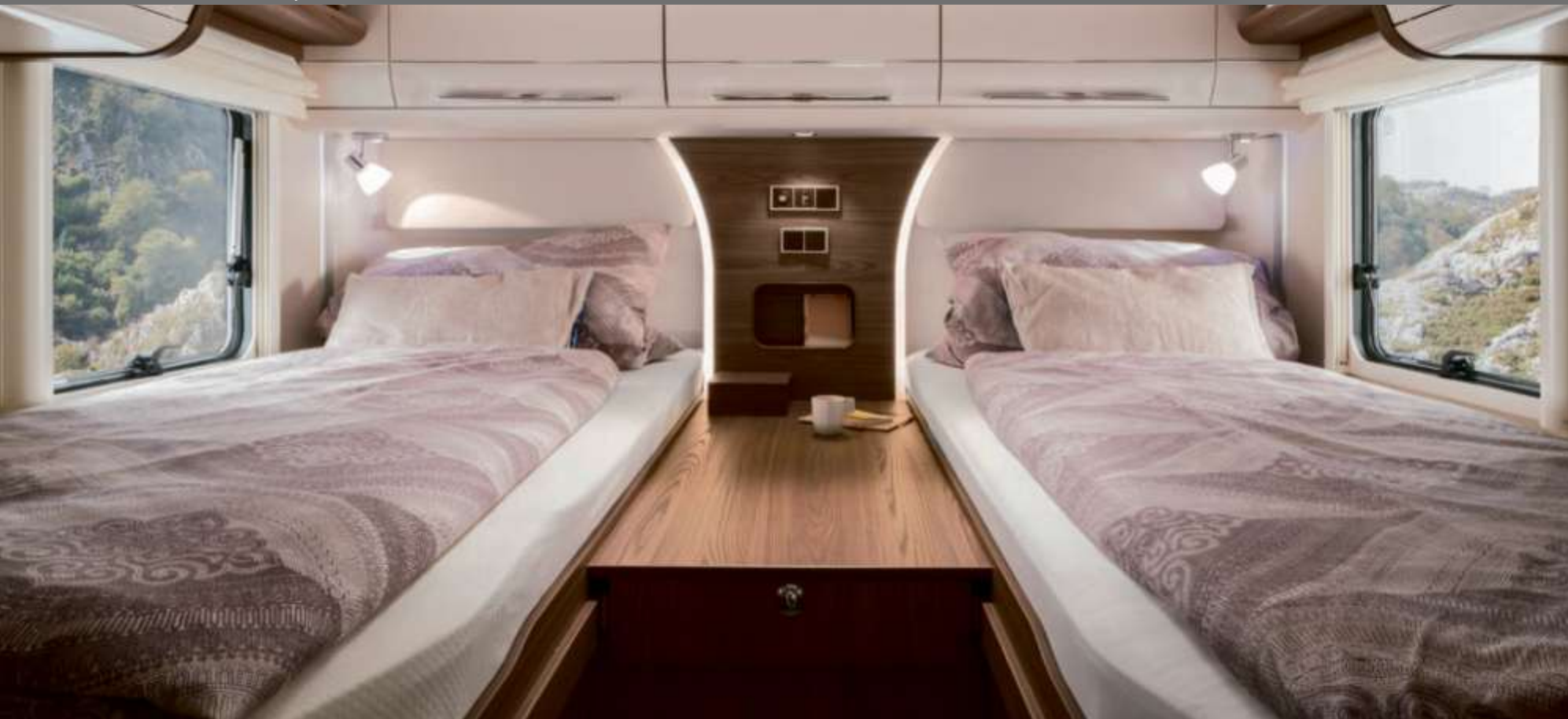
Einzelbetten oder Liegewiese. Die beiden großzügig gestalteten Einzelbetten im Heck des B 704 SL sind jeweils 200 cm lang und können serienmäßig zu einer riesen Liegefläche erweitert werden.
