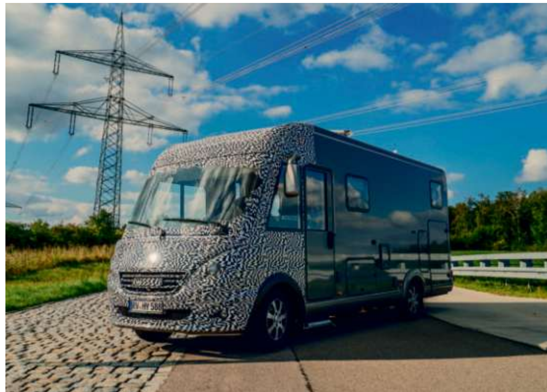
Während des Rüttelstrecken-Tests, der ein Vielfaches der Normalbelastung simuliert, werden die Reisemobile auf Herz und Nieren geprüft. Eine detaillierte Dokumentation gewährleistet die Optimierung des Prototyps auf dem Weg zum Serienmodell.
