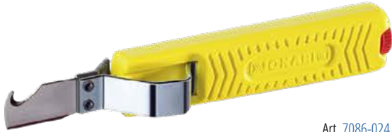
Art. 7086-024 zusätzlich mit TIN-beschichteter Hakenklinge zum Abisolieren von Steg- und Flachkabeln
