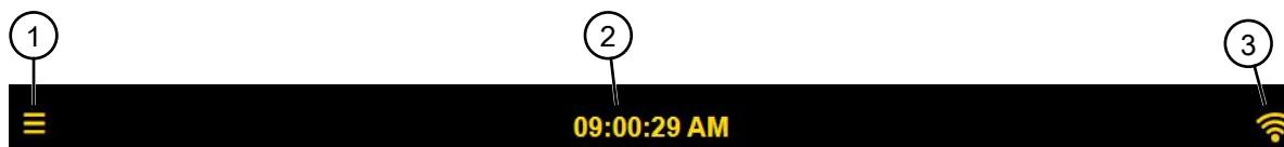
Fig. 2: Sulla barra di stato per le varianti SC senza mandrino cablato compare l'icona hamburger menu.
