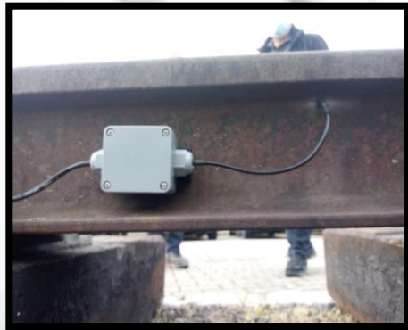
Sensorelektronik und im Schienenkopf verklebter Sensor
