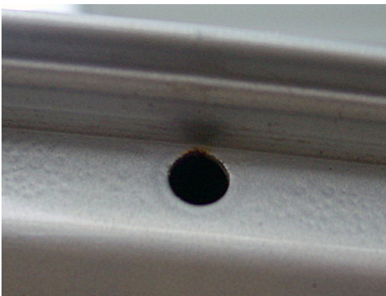
Bild 9-011 Bohrung für Hohlraumkonservierung Ursache ist: Unterbeschichtung durch Kantenflucht und ungenügende Hohlraumkonservierung
