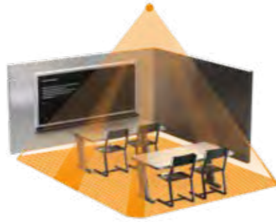
Situation Klassenraum, Erfassung durch den Presence Control Pro IR Quattro mit quadratischer Erfassungscharakteristik
