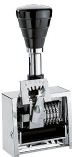
Erstklassige Beschaffenheit. Flexibel, für zahlreiche Ausführungsvarianten geeignet. Stabile Konstruktion mit Führungsrohr aus Messing. Glanzvernickeltes Metallgestell. 0,1 x - 4 x Schaltung, auch andere Schaltkombinationen möglich. Versenkbare Druckgussräder, 6- und mehrstellig lieferbar. 3,5 mm, 4,5 mm oder 5,5 mm Antiqua- oder Blockzahlen.
