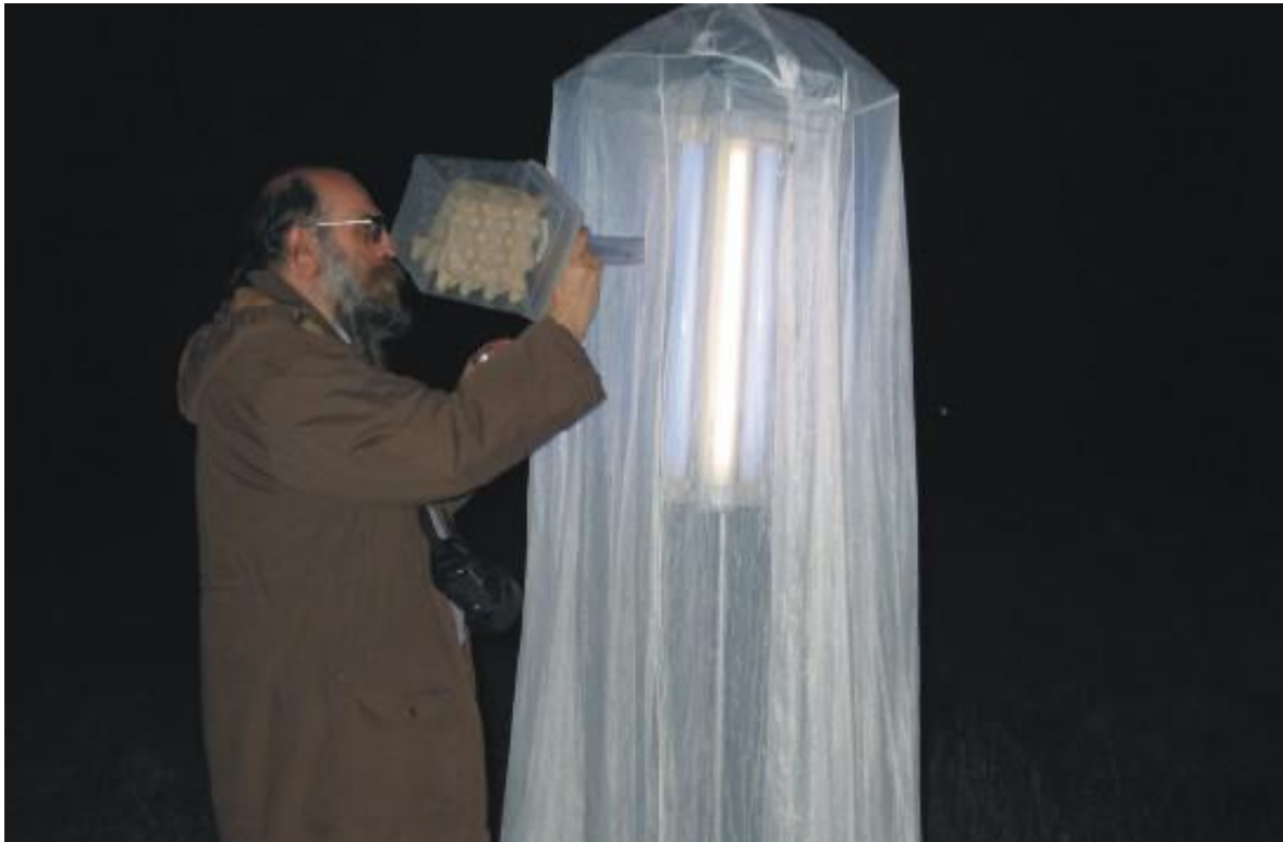
Abbildung 3-2: Präsenzlichtanlage im aufgebauten Zustand
