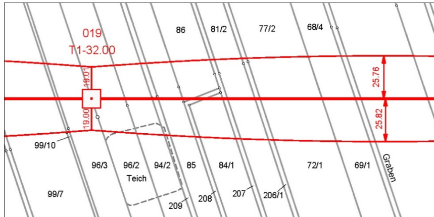
Abbildung 8: Beispiel parabolischer Schutzstreifen einer Freileitung
