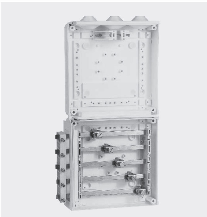
Einspeisegehäuse EK230 mit Sammelschienensystem Cu 12 x 5 mm, 5-polig zur seitlichen Einspeisung rechts oder links am Zählerschrank. (Sammelschienenanschlussklemmen Zubehör)
