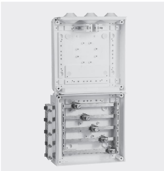
Einspeisegehäuse EK230 mit Sammelschienensystem Cu 12 x 5 mm, 5-polig zur seitlichen Einspeisung rechts oder links am Zählerschrank.
