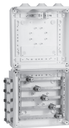
Einspeisegehäuse EK230 mit Sammelschienensystem Cu 12 x 5 mm, 5-polig zur seitlichen Einspeisung rechts oder links am Zählerschrank. (Sammelschienenanschlussklemmen Zubehör)
