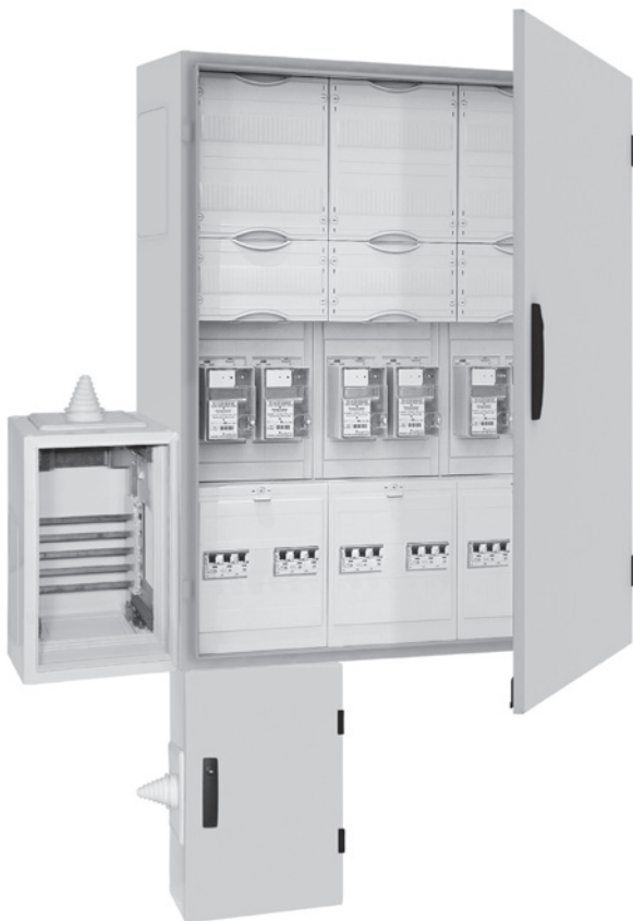
Einspeisegehäuse TZ622 zum Anbau unten oder TZ623 mit Sammelschienensystem Cu 12 x 5 mm, 5-polig zur seitlichen Einspeisung rechts oder links am TG...SZ-Zählerschrank. (Sammelschienenanschlussklemmen Zubehör)
