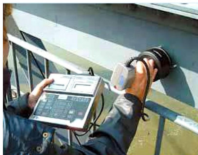
Photo 46 : Mesure de la couleur par colorimètre tri-stimuli (Extrait Guide LCPC Entretien de la protection anticorrosion des Ouvrages métalliques)
