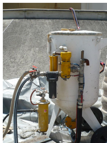
Photo 30 : Décapage à sec ; atelier et matériel © Prezioso Linjbygg
