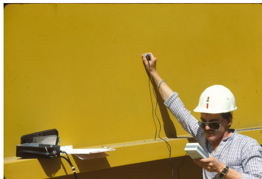
Photo 43 : Contrôle épaisseur peinture © JP Persy
