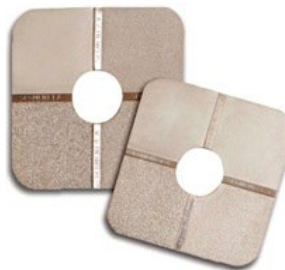
Photo 32 : Évaluation de la rugosité après décapage
