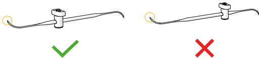
Рис. 2. Положение зажима для инструментов по отношению к точке, в которой осуществляется навигация
