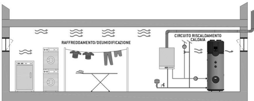
Warmwasserwärmepumpe in Sanitäranlagen mit einem Wand-Gasheizkessel
