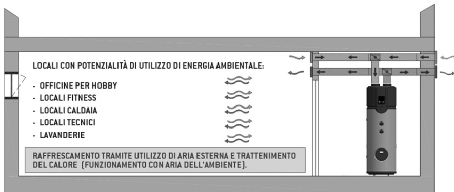
Warmwasserwärmepumpe in Sanitäranlagen mit Abluftset
