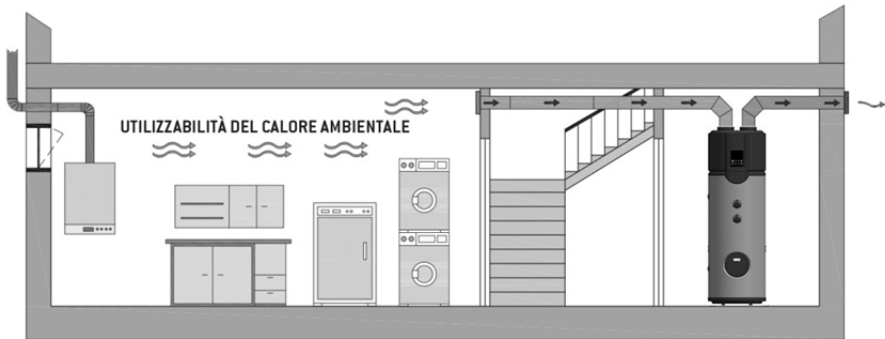
Warmwasserwärmepumpe mit Luftleitungen (Zufuhr-Luft - Abgabe-Luft)
