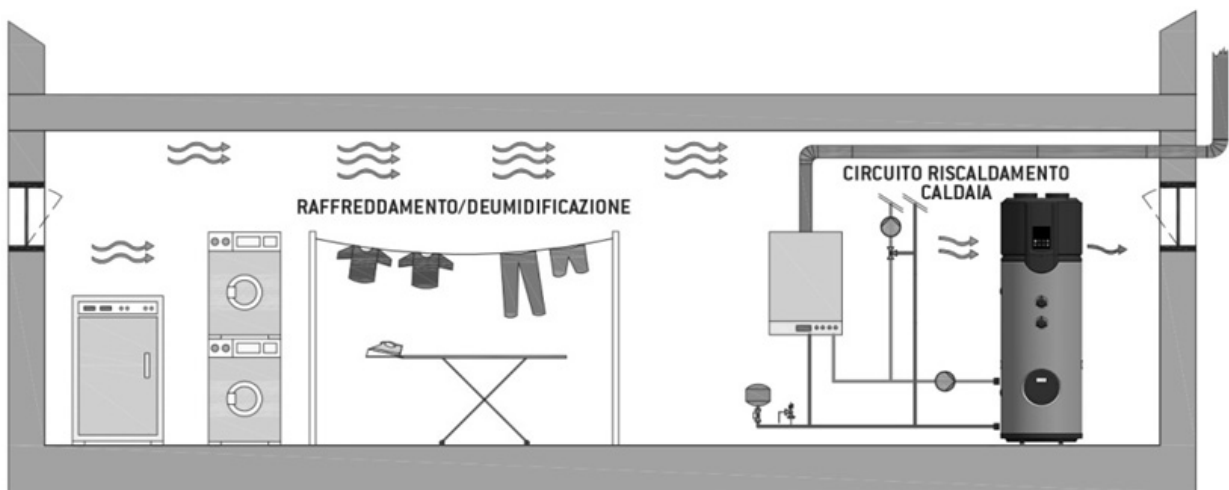
Warmwasserwärmepumpe in Sanitäranlagen mit einem Wand-Gasheizkessel
