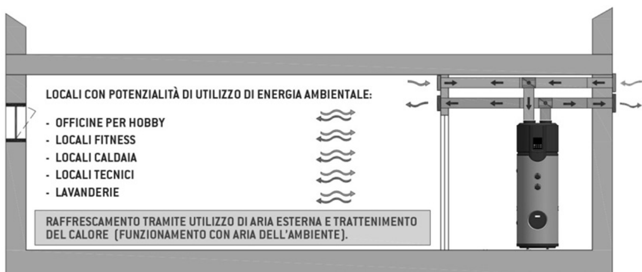
Warmwasserwärmepumpe in Sanitäreanlagen mit Abluftset
