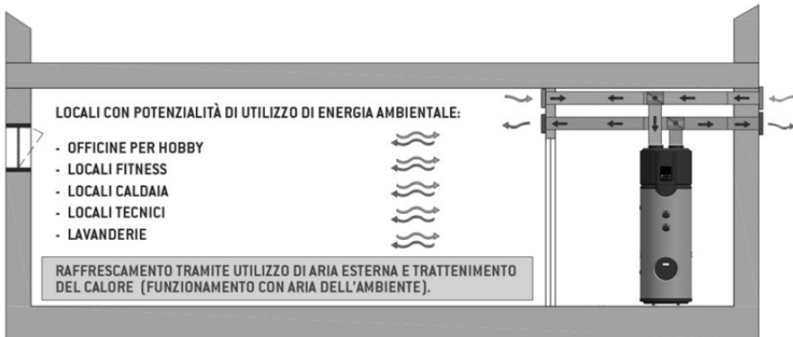
Warmwasserwärmepumpe in Sanitäranlagen mit Abluftset
