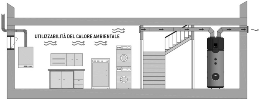
Warmwasserwärmepumpe mit Luftleitungen (Zufuhr-Luft - Abgabe-Luft)
