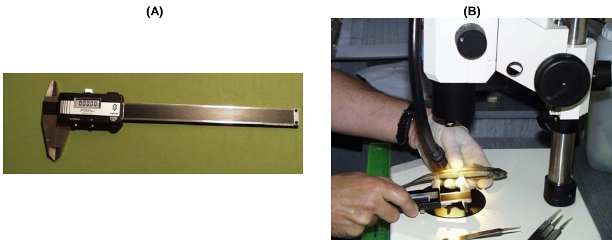
Figura 4. (A) Pié de metro digital Fowler Ultra Cal II y (B) Medición y recuento bajo microscopio estereoscópico Zeiss SV-11.
