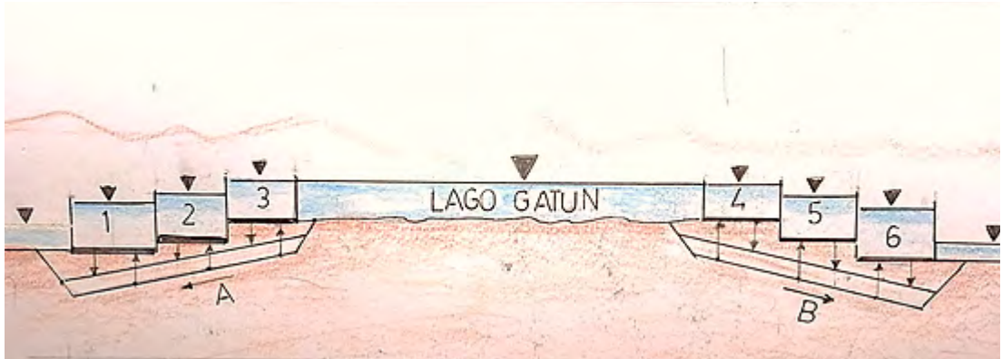
▲ Fig. 15. Sezione chiuse. Dall'Oceano Atlantico le imbarcazioni da Colon iniziano la navigazione lungo l'istmo di Panama. Le tre chiuse di Gatun (1-2-3) con tre passaggi consecutivi determinano la salita al bacino del lago artificiale di Gatun a un livello superiore dell'oceano Atlantico di 26 metri. Dopo avere attraversato il lago, le chiuse di Pedro Miguel e Miraflores, allo stesso modo, fanno scendere le navi al livello dell'Oceano Pacifico. Il saliscendi viene ottenuto tramite due condotti sotterranei A e B al fondo che tramite un complesso sistema di regolazione invia acqua dal lago al fondo delle chiuse per la salita delle navi, oppure le svuotano per la discesa di livello. La navigazione dalla 1 alla 6 misura 81 km di lunghezza.
