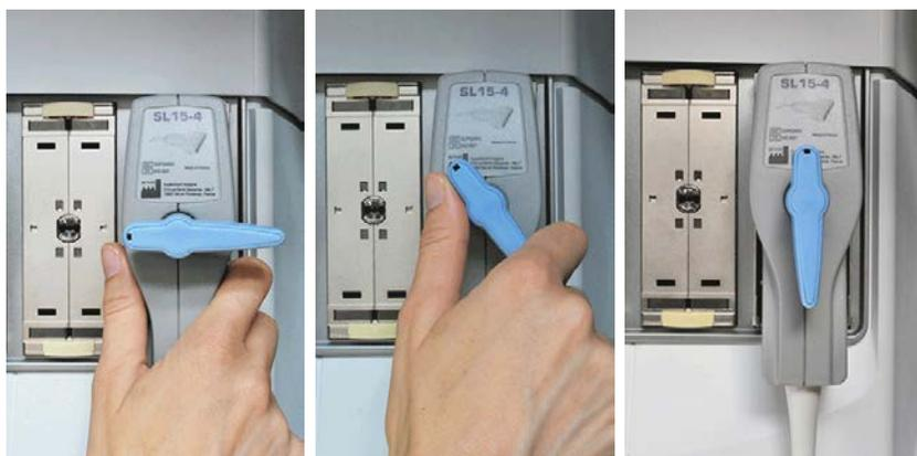
Cuando desconecte el transductor, gire el pomo de bloqueo en sentido contrario a las agujas del reloj para desbloquear el conector y, después, sujete éste y tire de él.
