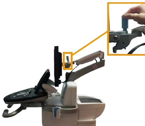
Para trasladar el equipo, coloque el monitor en la posición más baja y gire el tornillo en sentido de las agujas del reloj a fin de bloquearlo en esta posición.
