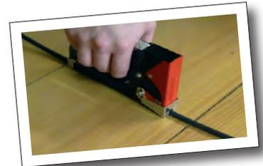
Kraftvolles Gerät aus Metall für die Befestigung von Plastikabdeckungen, Isolationsmaterialien, dünnen Teppichböden auf Holzunterkonstruktionen
